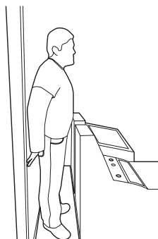
Acceso mínimo para mantenimientos
