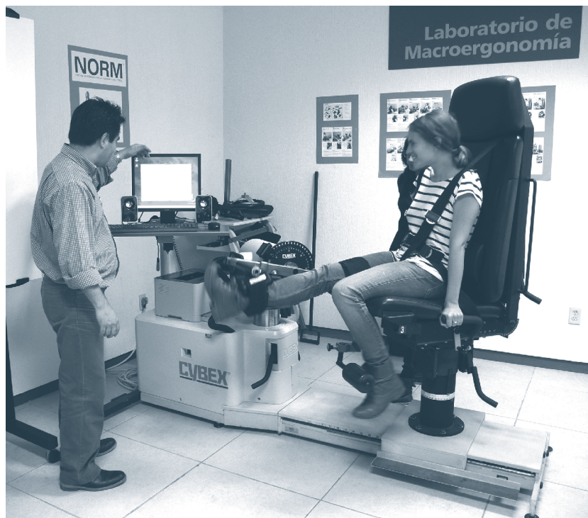
Figura 8. Dinamómetro Cybex. Laboratorio de Macroergo- nomía.
