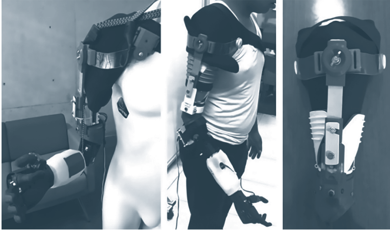
Figura 6. Prótesis mecatrónica (CIDI, IIMAS, Facultad de Medicina UNAM). Fuente: Colección del autor.
