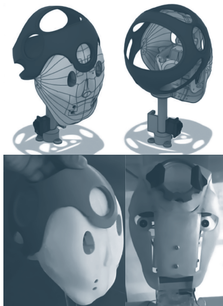
Figura 9. Desarrollo de prototipos electromecánicos faciales para el estudio de interacción usuario-robot (CIDI, UNAM, Laboratorio de Robótica). Fuente: Colección del autor.
